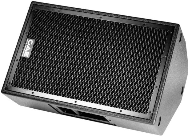
Der GAE 152M Bühnenmonitor ist ein passives Vollbereichslautsprechersystem, das mit einem 15"-Tiefmitteltöner und einem horngeladenen 1,5"-Druckkammerlautsprecher bestückt ist und nach dem Bassreflexprinzip arbeitet. Die Hornkonstruktion ist aus Glasfaserlaminat gefertigt und extrem widerstandsfähig gegenüber mechanischen Einflüssen. Die passive Frequenzweiche ist optimal auf die verwendeten
